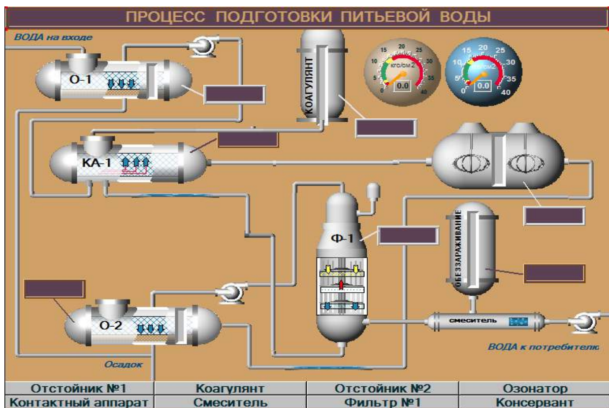
Рисунок 2 - Имитационная модель системы в TRACE MODE
