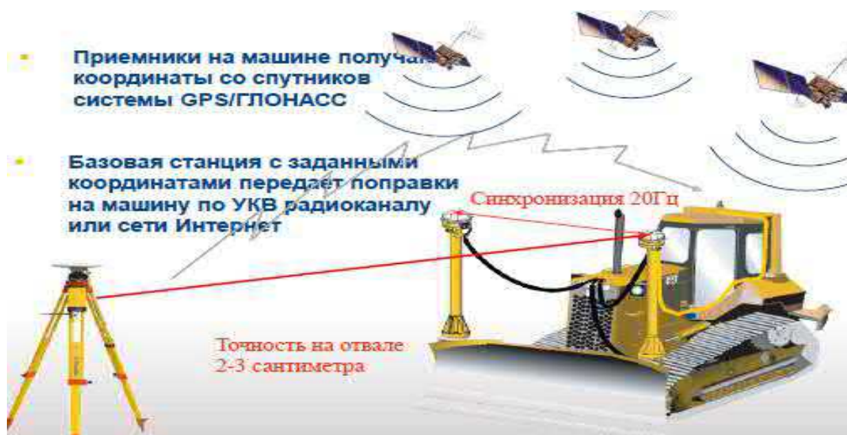
Рисунок 1 - 3D Система GPS/ ГЛОНАСС. Как это работает?
