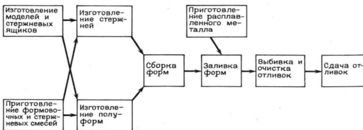
Рисунок 1 – Технологический процесс изготовления отливок в песчаных формах
