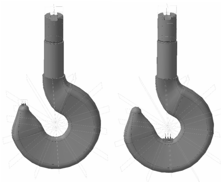
Рисунок 1 – 3D-модель с приложенными нагрузками
