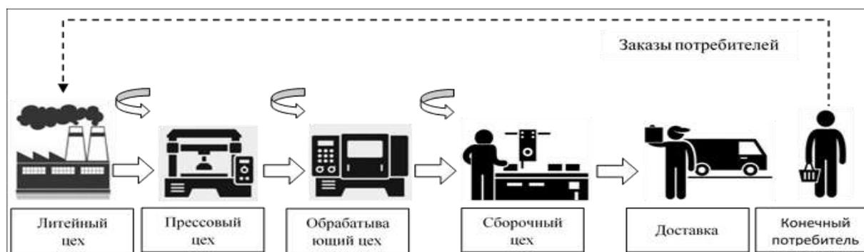
Рисунок 2 – Система «вытягивающего» типа
