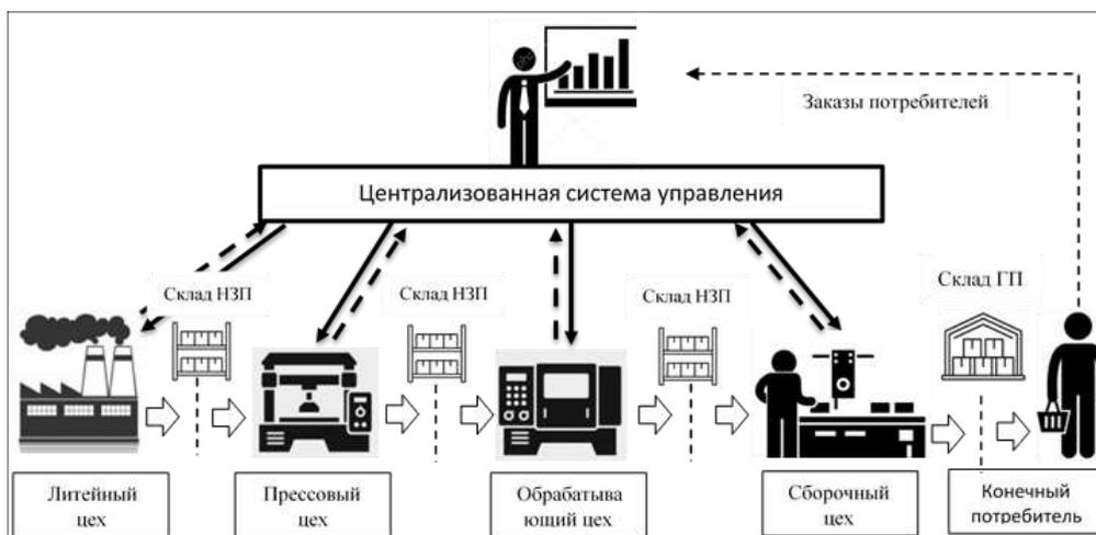
Рисунок 1 – Система «толкающего» типа
