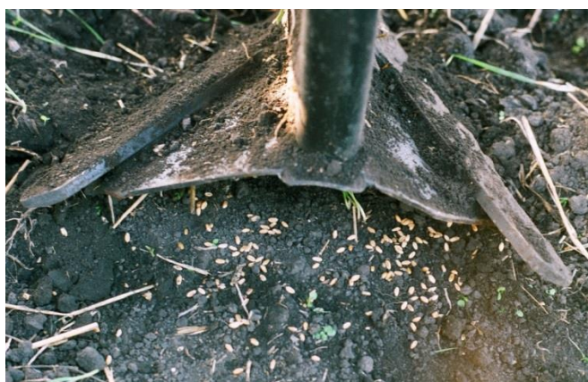
Фото 2 - Модернизированный рабочий орган культиватора КФГ-3,6 для разбросного посева зерна по стерне
