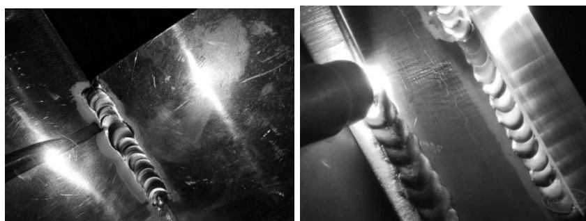
Рисунок 2 - Типы и качество сварных швов, выполняемые специалистом средней квалификации при применении сварочного аппаратов Ws-200и ПДГ-312-5. Стыковой шов
