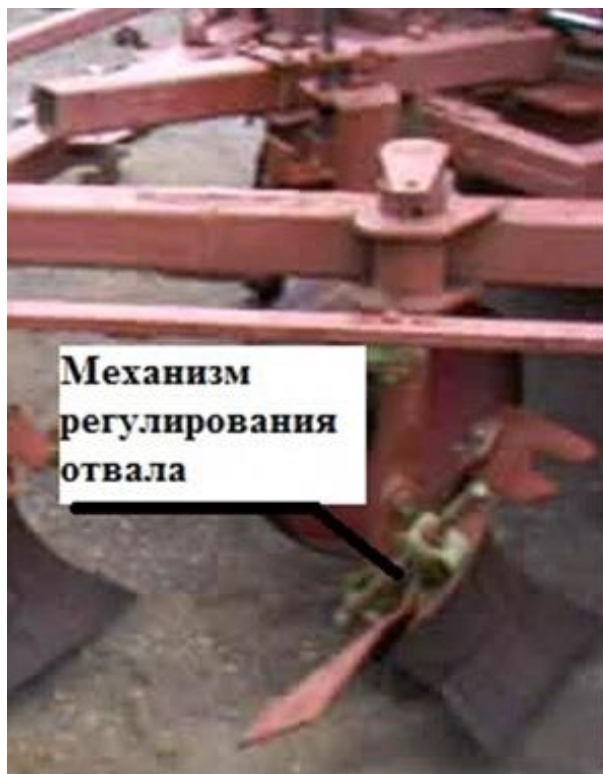
Рисунок 2 – Винтовой механизм для регулирования формы отвала
