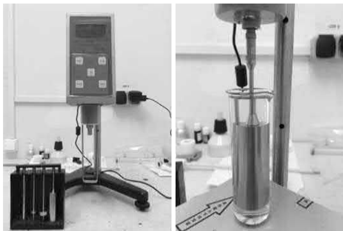
Рисунки 11 и 12 – Измерение вязкости составов с помощью прибора вискозиметра
