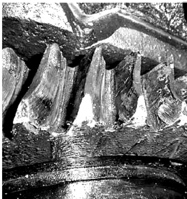
Рисунок 4 – Износ червячного колеса
