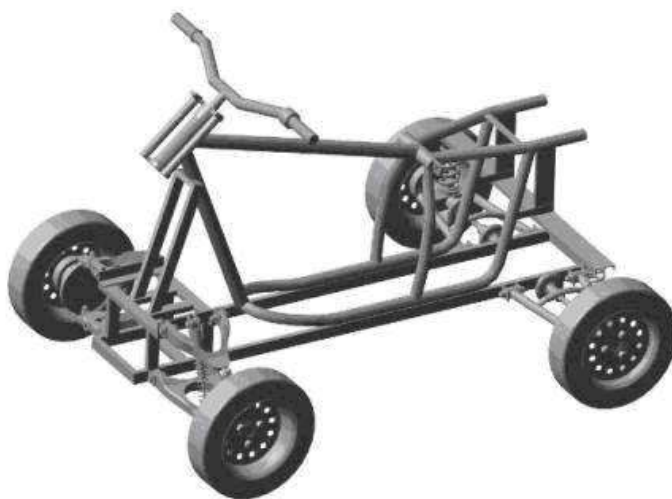
Рисунок 1 – 3D модель разработанного каркаса квадроцикла
