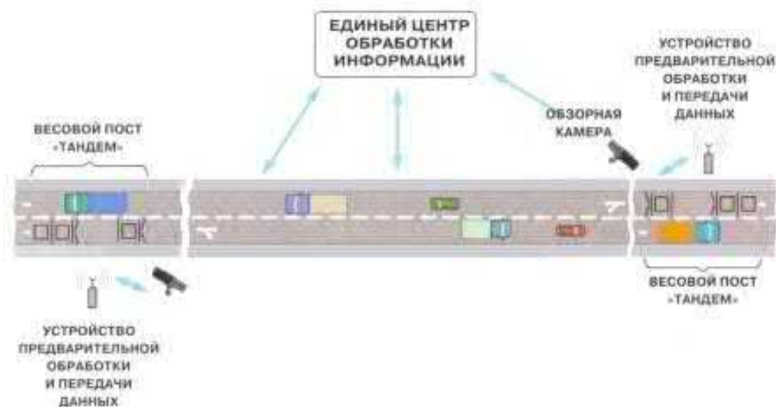
Рисунок 1 - Схема весового комплекса
