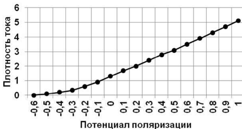
Рисунок 1 – График изменения плотности тока (мА/см 2 ) в зависимости от потенциала поляризации (В) электрода (сталь Ст.3) в пробах воды артезианских скважин
