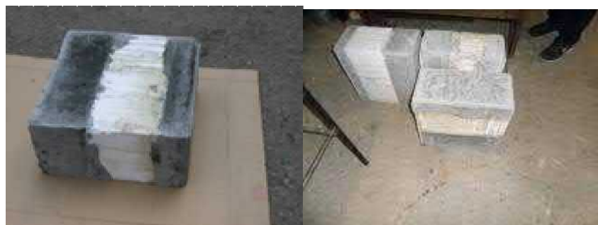
Рисунок 1 - Трехслойный теплоэффективный стеновой блок (Полиблок)
