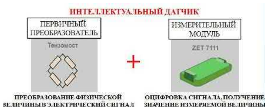
Рисунок 6 – Устройство интеллектуального тензодатчика ZET 7111 Tensometer-CAN
