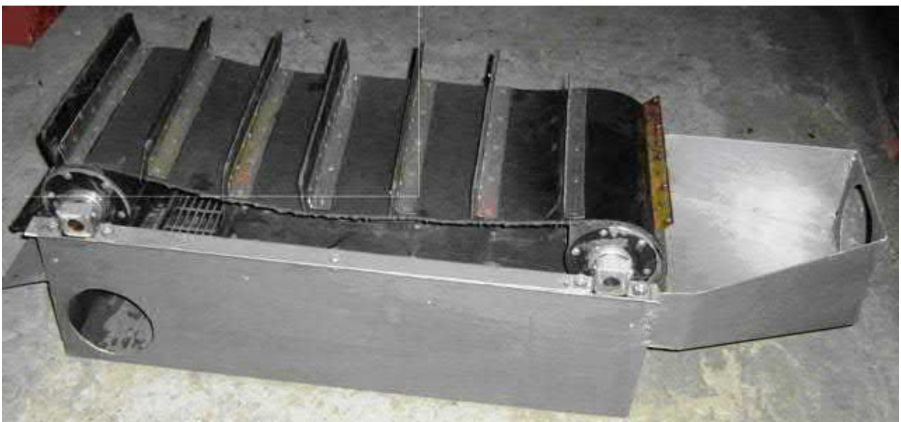
Рисунок 4 – Устройство для улавливания твердых биологических отходов домашней канализации
