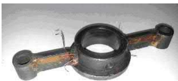
Рисунок 5 – Составляющие для измерения момента а) полумуфта; б) токосъемник
