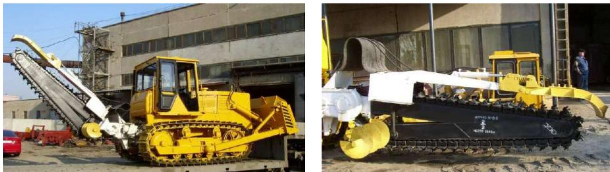
Рисунок 1 - Рабочий орган на базе Т-170 (Т-130) с отвалом
