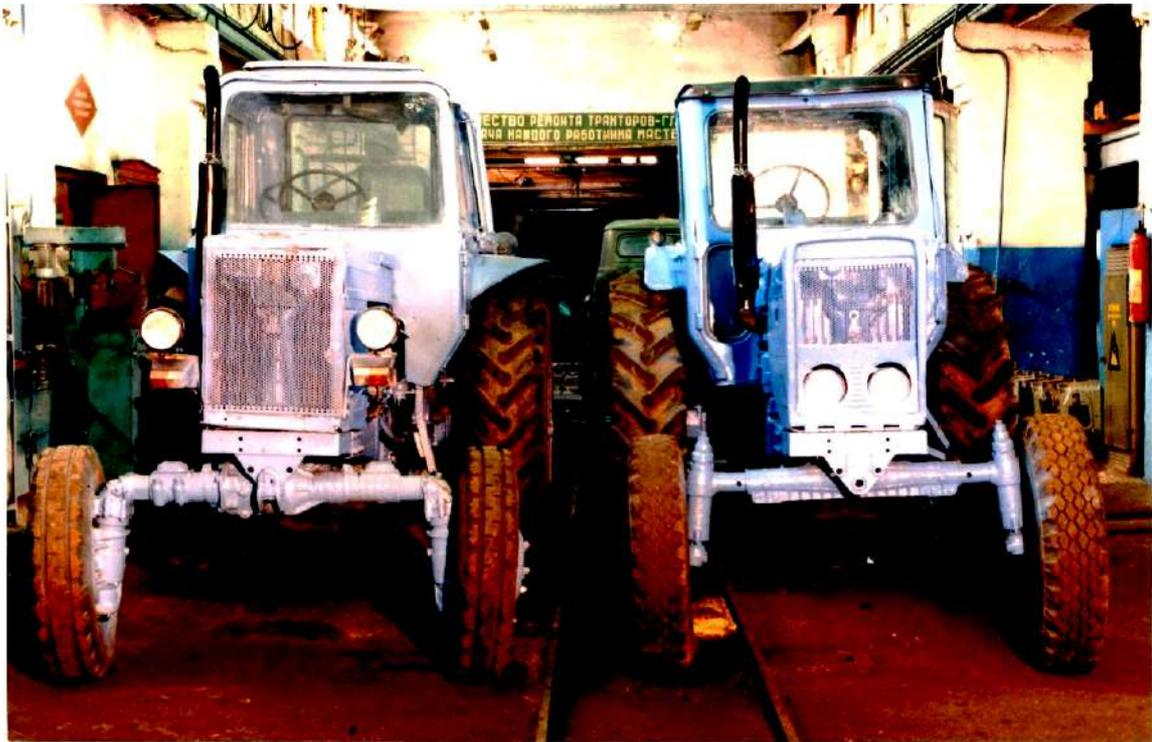
Отремонтированный трактор МТЗ-50 (справа), модернизированный от трактора МТЗ-52 в МТЗ-82 (слева)
