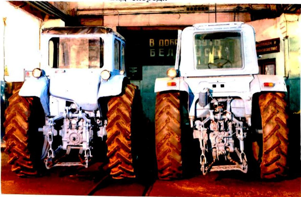
Отремонтированный трактор МТЗ-50 (слева), модернизированный от трактора МТЗ-52 в МТЗ-82 (справа)
