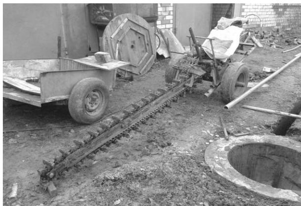
Рисунок 2 - Разработанная конструкция траншекопателя
