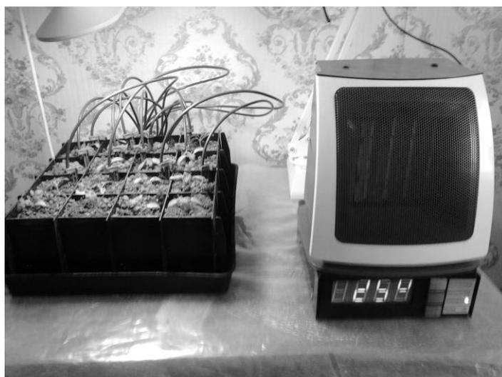
Рисунок 3 - Фотография установки для выращивания растений с программируемым устройством управления
