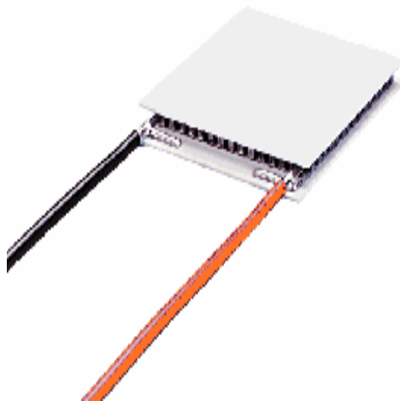
Рисунок 1 - Модуль Пельтье: а) структура модуля; б) внешний вид
