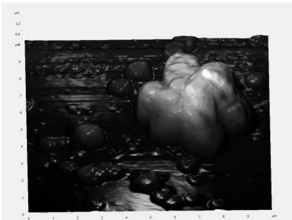
Рисунок 2 - Изображение в АСМ частиц осажденного коллоидного серебра и их скоплений – агломерат.
