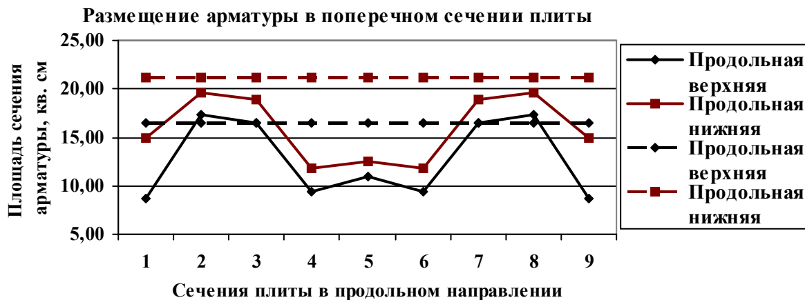
Рис. 3. Диаграмма распределения продольной арматуры по сечениям плиты длиной 3,0 м, шириной 1,0 м, толщиной 0,14 м
