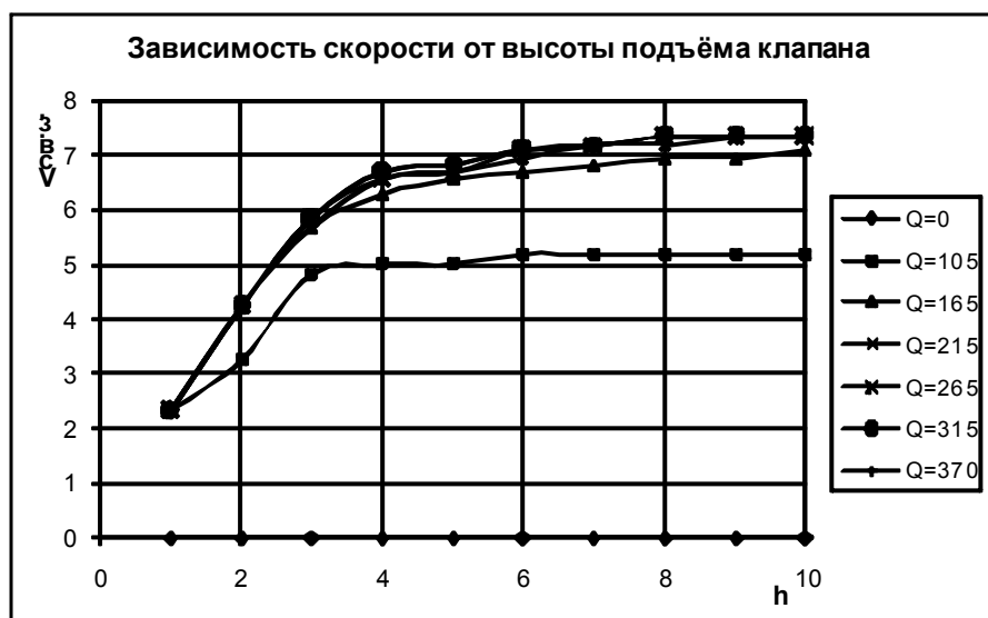
Рис. 1. Зависимости скорости от высоты подъема клапана
