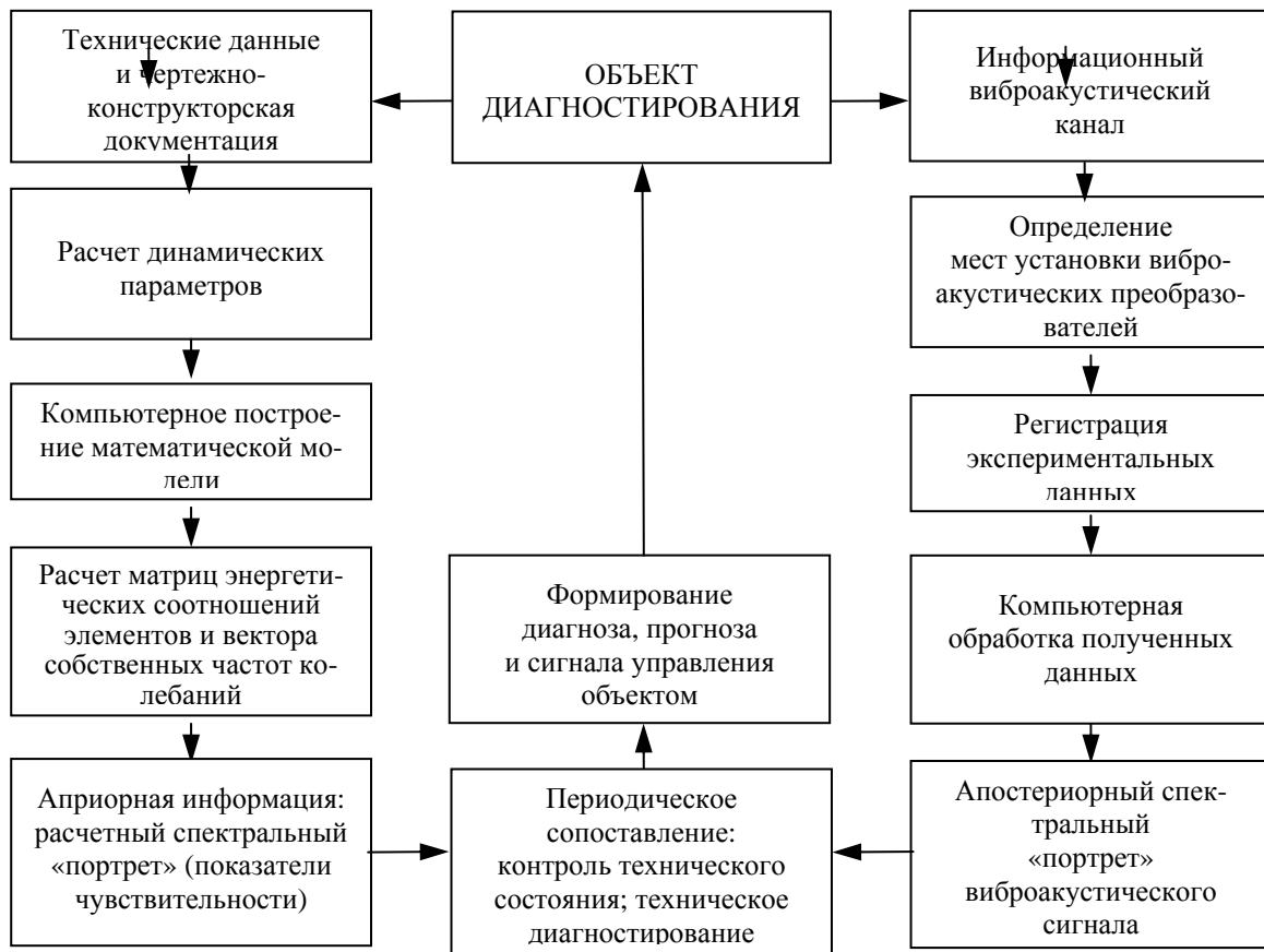
Рисунок 2 - Структурная схема методов повышения эффективности диагностирования СЭУ
