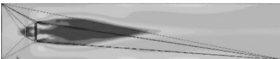
Рисунок 4 - Схема границ каверны, формируемых кольцевым крылом с круглым сечением профиля ( D = 160 мм и a = 100 мм).
