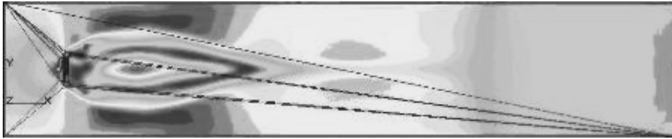
Рисунок 6 - Схема границ каверны при размещении кольцевого крыла с круглым сечением профиля вблизи кавитатора ( D = 130 мм и a = 10 мм).
