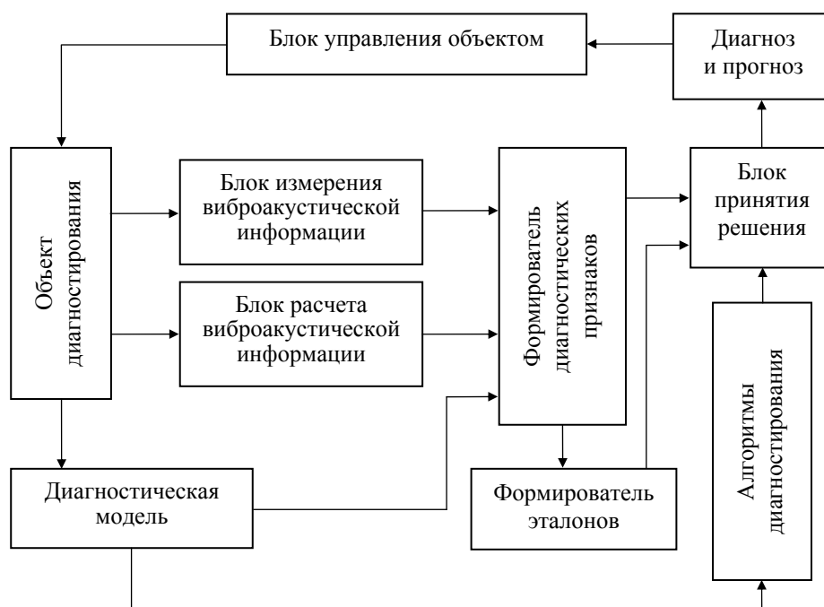
Рисунок 2 - Структурная схема системы виброакустического диагностирования (дополненной методами повышения эффективности диагностического контроля)
