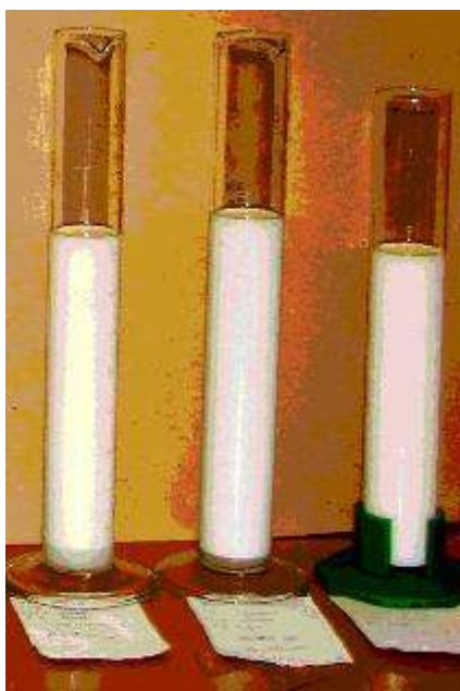
Рис. 1. Градуированные пробирки с МТЭ, присадка сукцинимид С-5А, содержание воды – 7 %, различное содержание метанола, слева направо: 10, 20 и 30 % (масс.)
