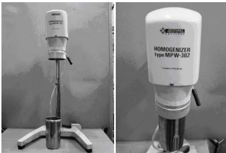
Рис. 1. Общий вид гомогенизатора для приготовления эмульсий
