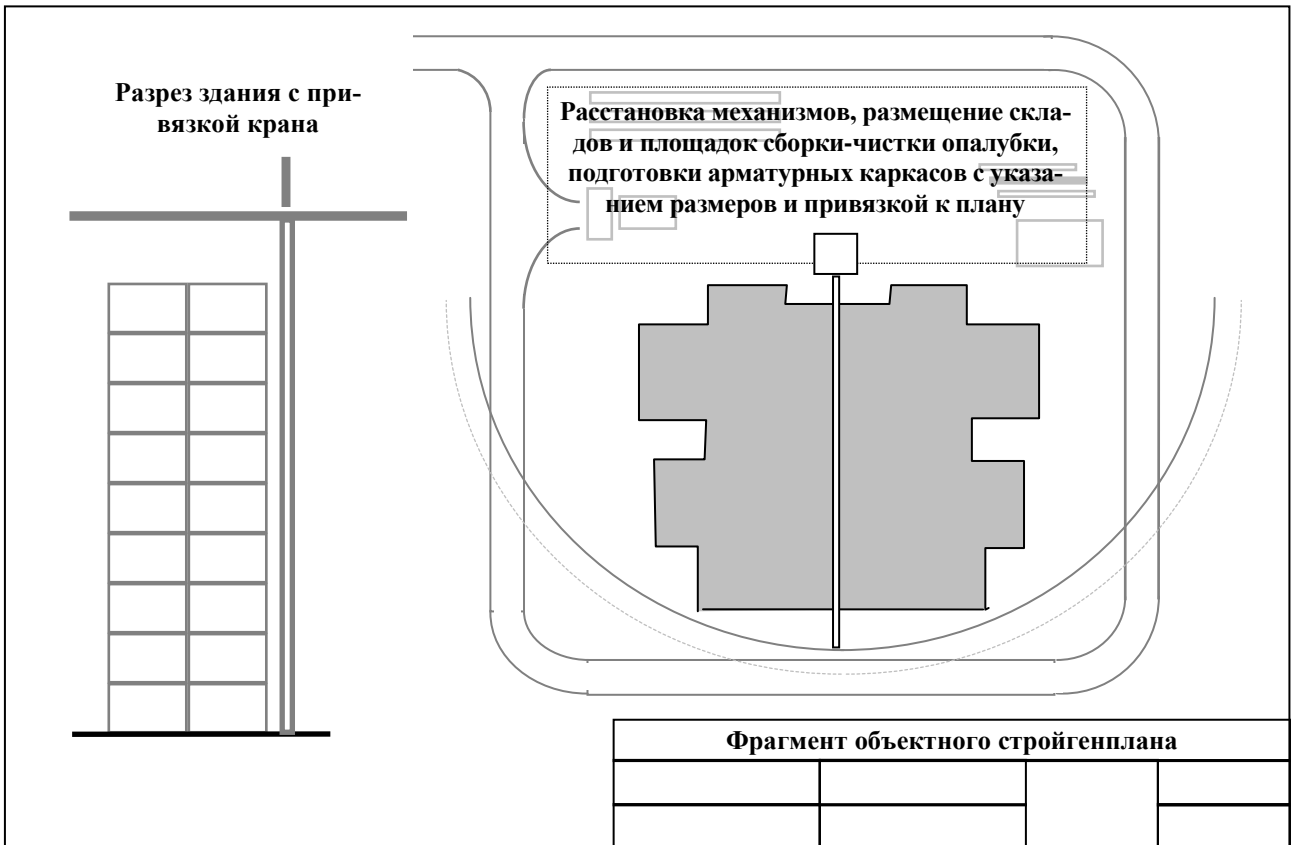
Рис. 5. Примерная компоновка графических листов формата А3 при оформлении решений по стройгенплану и календарному плану работ на объекте
