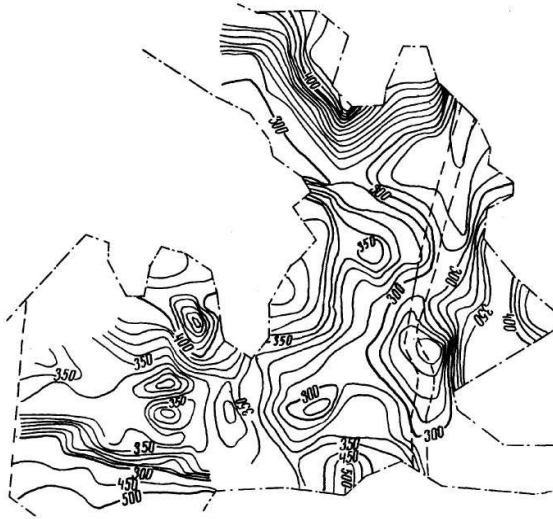
Рис. 3.17. План изолиний прочности поддерживающих целиков (диаметр целика 8 м) залежи «Кресте – 4 – 1».
