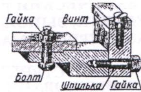
**47 СООТВЕТСТВИЕ НАГЛЯДНЫХ ИЗОБРАЖЕНИИ С ОРТОГОНАЛЬНЫМИ ЧЕРТЕЖАМИ СОЕДИНЕНИЙ КРЕПЕЖНЫМИ ДЕТАЛЯМИ**
