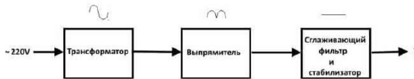
Рисунок 2 – Функциональная схема трансформаторного блока питания
