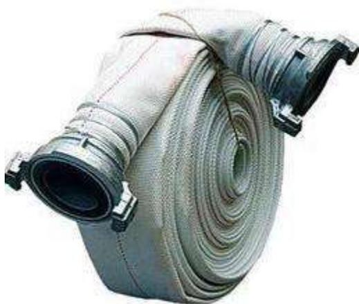
**ПОЖАРНЫЙ РУКАВ** - Рукава с внутренней гидроизоляционной камерой поставляются в скатках по 20-40 метров и рассчитаны для работы под давлением до 1,0 Мпа. Они должны быть сухими, хорошо скатанными и присоединенными к кранам и стволам.
