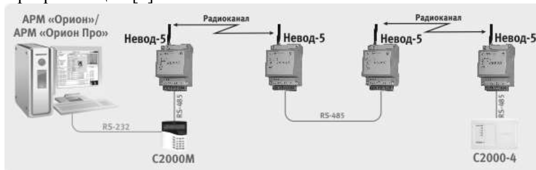
Рисунок 1 – Построение сети беспроводной передачи данных с использованием ПО «Орион Про»
