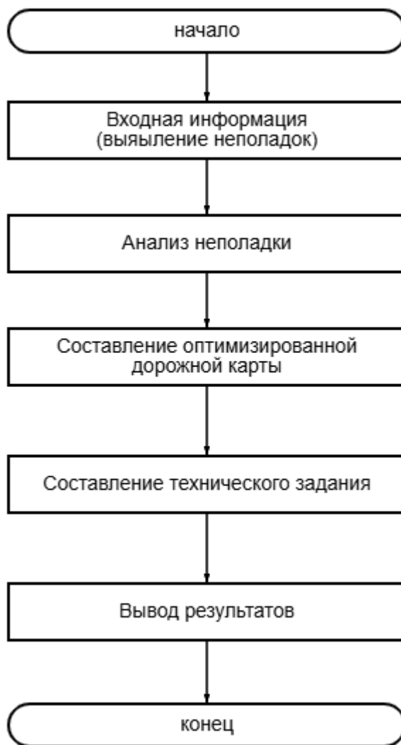
Рисунок 1 – Алгоритм автоматизации выявления и устранения неисправностей
