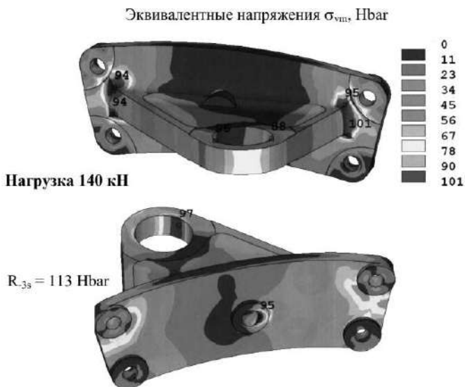
Рисунок 1 – Распределение напряжений в детали [1].
